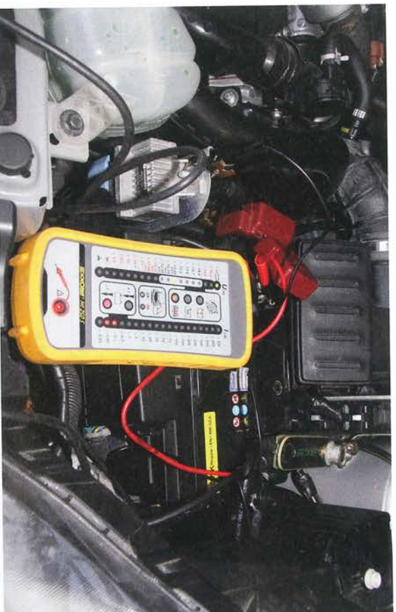
Un contrôleur de batterie dédié, ici le MI250S d'Exxorest, affiche instantanément l'état de la batterie et permet de mesurer des courants de fuite, la consommation du démarreur, etc.
