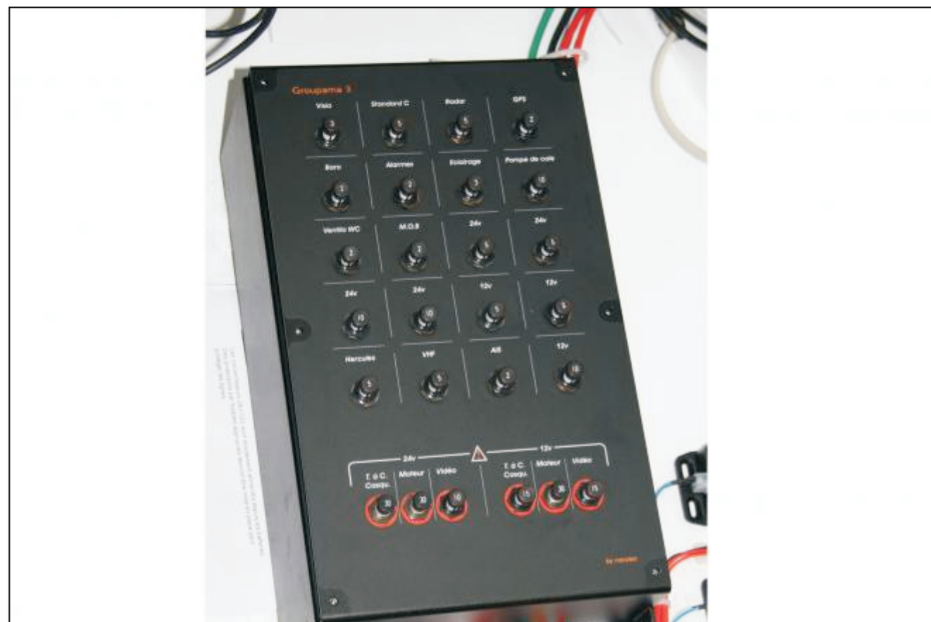
Voilà le tableau électrique général de Groupama 3. Certains réseaux bien identifiés sont en 24 V pour limiter la section du câblage et ainsi gagner du poids. Les disjoncteurs sont de type aéronautique.
