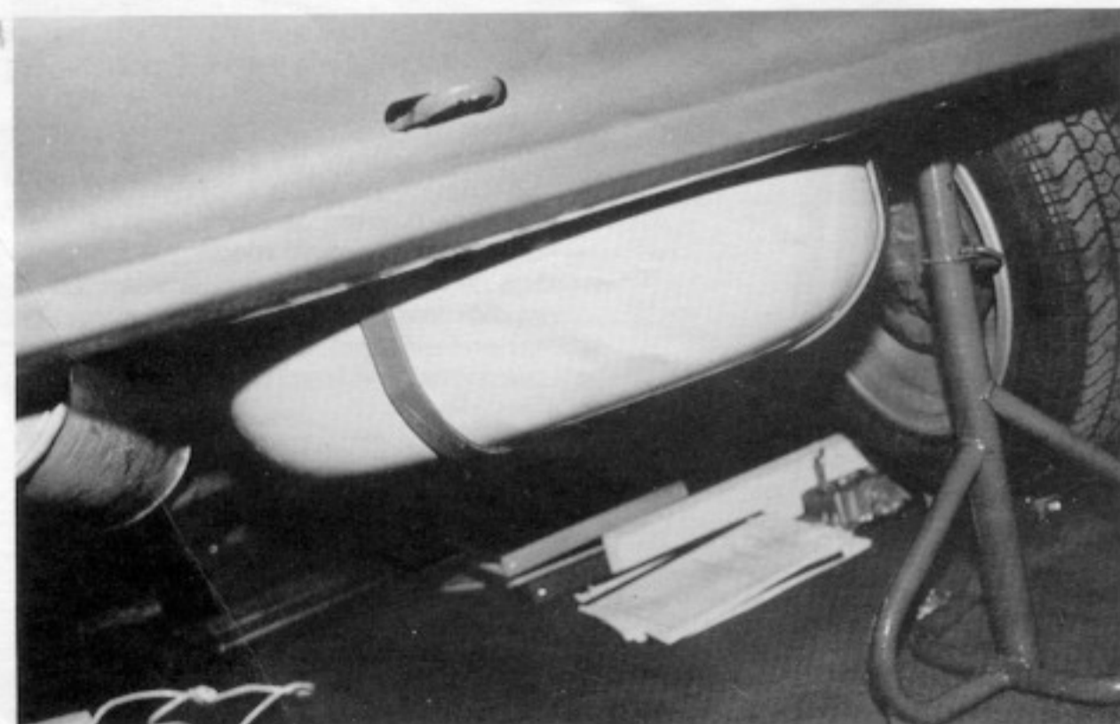
Implantation d'un réservoir annulaire sous le plancher de coffre d'une Citroën AX. (photo Auto-Volt)
